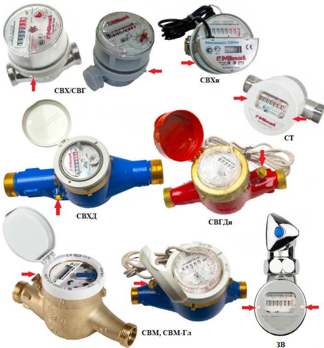
Рисунок 1 – Общий вид счётчиков с указанием мест пломбирования
